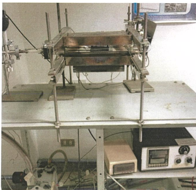
รูปที่ 3.3 ระบบการเตรียมฟิล์มบางโดยวิธีระเหิดสารเคมีด้วยความร้อนในระยะประชิด
