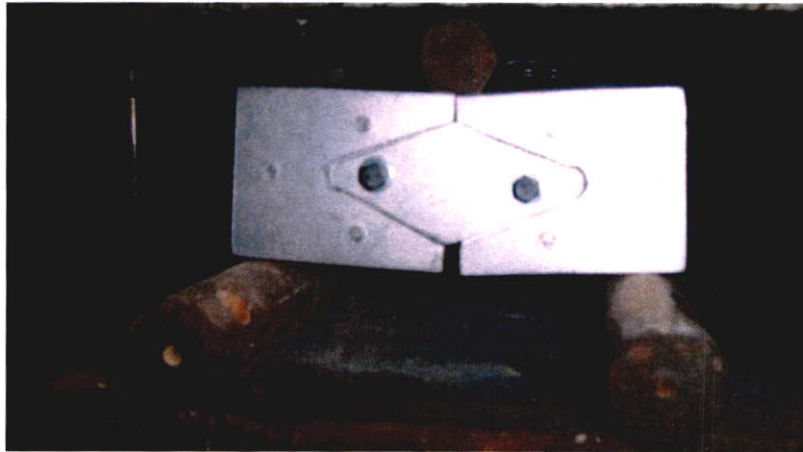
ภาพที่ 3.11 ภาพการทดสอบการรับกำลังของชุดต่อผนัง
