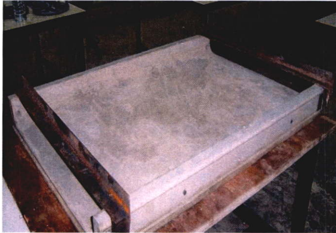
ภาพที่ 5.1 ภาพชุดอุปกรณ์จับยกแผ่นผนังรูปตัวซี
