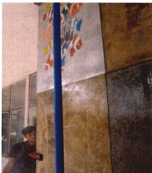
ภาพที่ 4.10 แสดงการทดสอบการต้านทานการซึมผ่านของน้ำฝนโดยไม่ใช่หมันอุครรอยต่อใดๆ
