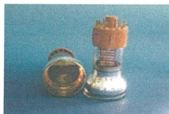
รูปที่2.20 ภาพหัววัดรังสีที่ประกอบด้วยผลึก NaI(Tl) และหลอด PM
