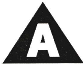
ภาพที่ 4.71 ไฟประเภท A มีสัญลักษณ์รูปตัว A อยู่ในสามเหลี่ยมสีเขียว
