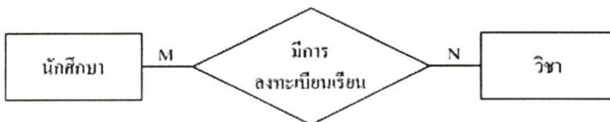
ภาพที่ 2.21 แสดงการใช้สัญลักษณ์แทนความสัมพันธ์ในแผนภาพแบบ E-R แบบกลุ่มต่อกลุ่ม
