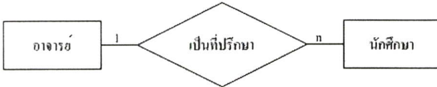
ภาพที่ 2.20 แสดงการใช้สัญลักษณ์แทนความสัมพันธ์ในแผนภาพแบบ E-R แบบหนึ่งต่อกลุ่ม
