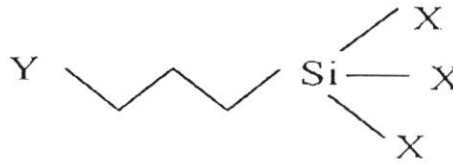
รูปที่ 2.11 โครงสร้างทั่วไปทางเคมีของ Organofunctional silane [25]
