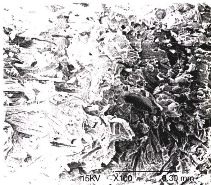
(ก) ภาพ SEM แสดงพื้นผิวรอยแตกหักของไม้พอลิเมอร์คอมโพสิต ขนาดกำลังขยาย 100 เท่า
