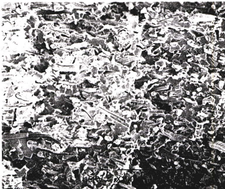
(ก) ภาพ SEM แสดงพื้นผิวรอยแตกหักของไม้พอลิเมอร์คอมโพสิต ขนาดกำลังขยาย 100 เท่า
