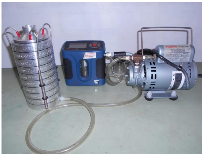
รูปที่ 3.4 การต่อเครื่องสอบเทียบอัตราการไหลเข้ากับ 8-stage cascade impactor
