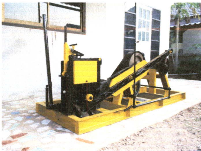
ภาพที่ ค.5 เครื่องอัดบล็อกดินซีเมนต์โดยใช้เทคนิคเชิงกลไก
