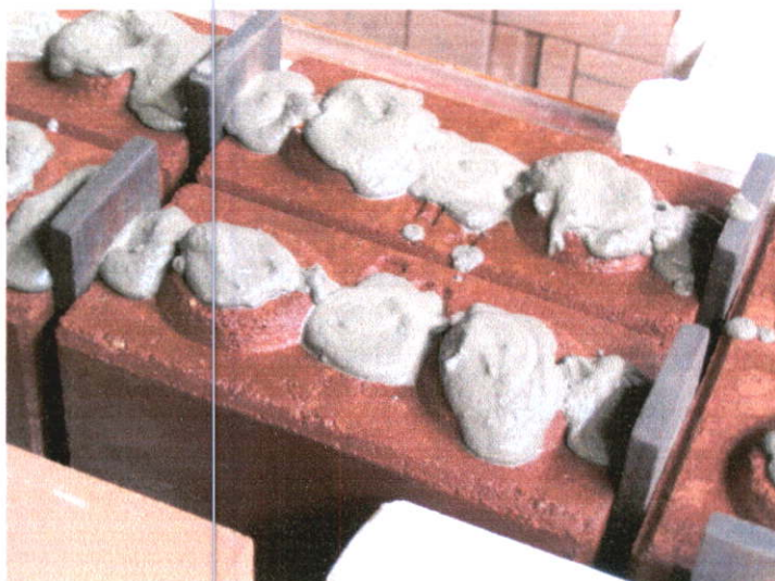
ภาพที่ ง.12 การทดสอบมาตรฐาน ขั้นตอนการหยคน้ำปูน
