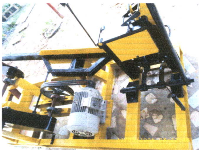
ภาพที่ ค.6 เครื่องอัดบล็อกดินซีเมนต์โดยใช้เทคนิคเชิงกลไก
