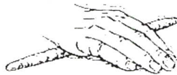
ภาพที่ 2.8 การตรวจสอบประเภทของดิน โดยการกลึงให้เป็นแท่งกลม
