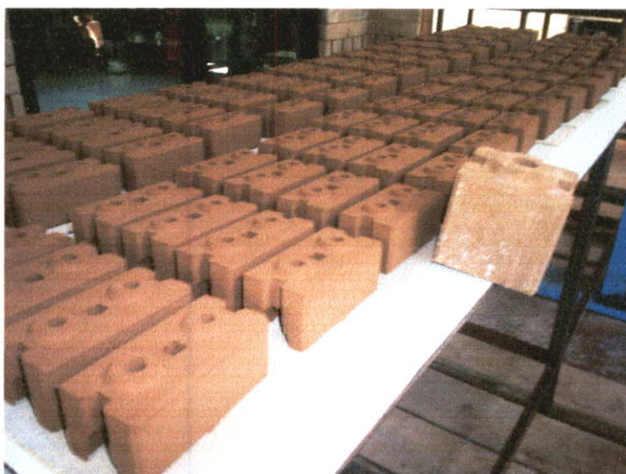
ภาพที่ ๓.๘ การสำรวจข้อมูลบล็อกดินซีเมนต์
