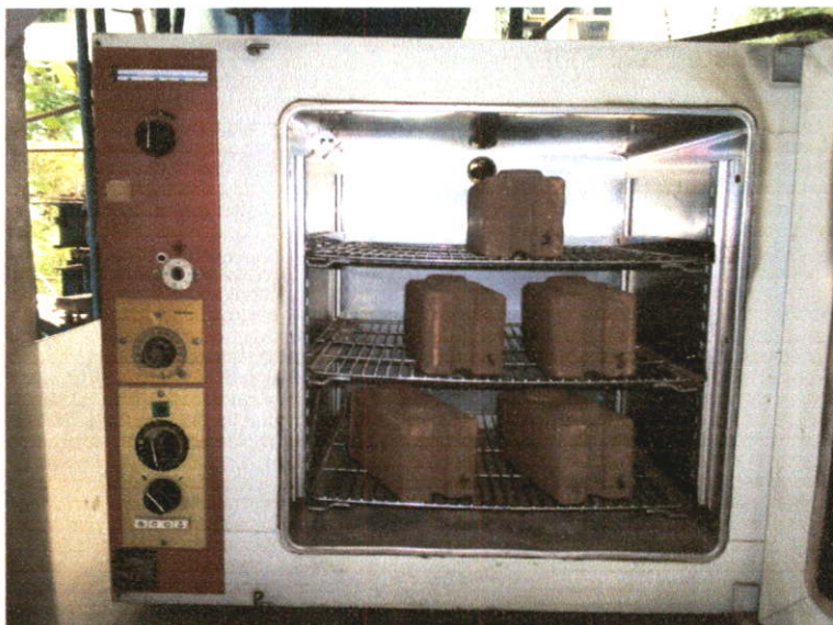
ภาพที่ ง.17 การทดสอบมาตรฐาน ขั้นตอนการเข้าเตาอบแห้ง
