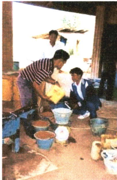
ภาพที่ 2.23 การนำดินลูกรัง ปูนซีเมนต์ และน้ำ มาหาสัดส่วนที่เหมาะสม
