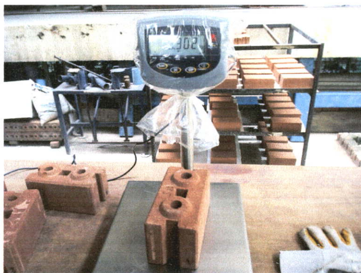
ภาพที่ ง.20 การทดสอบมาตรฐาน ขั้นตอนการชั่งนน.แห้ง
