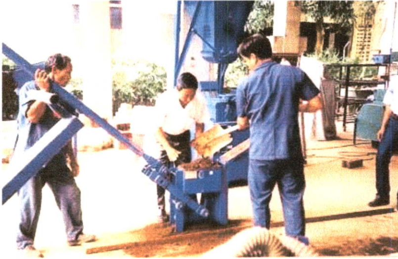
ภาพที่ 2.26 การตัดส่วนผสมลงในแบบอัด
