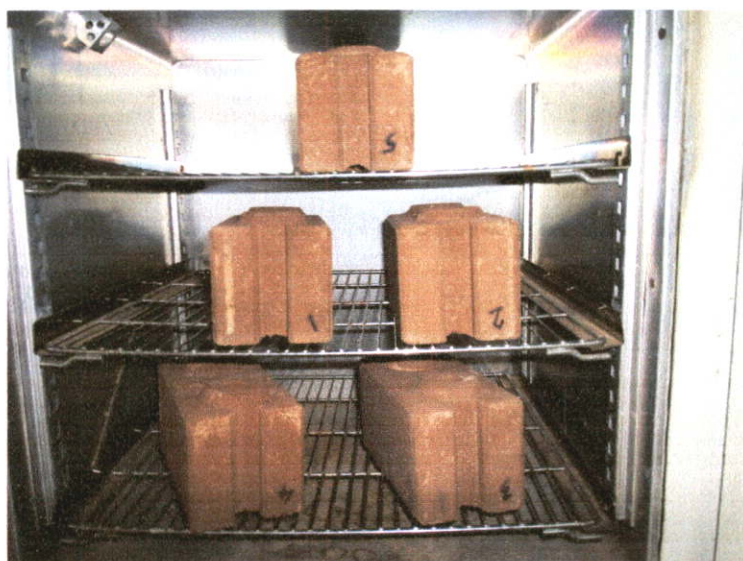
ภาพที่ ง.18 การทดสอบมาตรฐาน ขั้นตอนการเข้าเตาอบแห้ง
