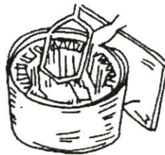
รูปที่ 2.5 การใส่ขดลวดลงในร่องสล๊อท
