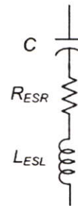
(ข) ความต้านทานและความเหนี่ยวนำแฝง ของตัวเก็บประจุ
