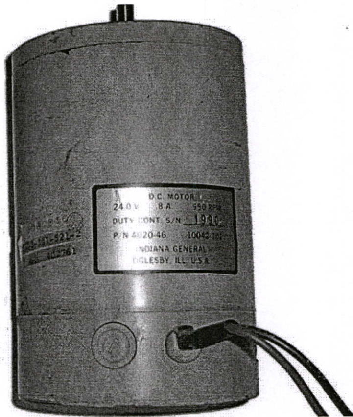
รูปที่ ก.3 แสดง มอเตอร์ไฟฟ้ากระแสตรงที่นำมาทำเป็น โหลดทดลอง
