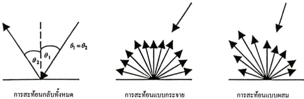
รูปที่ 2.4 เปรียบเทียบปรากฏการณ์การสะท้อนแสงในลักษณะการสะท้อนกลับหมด การสะท้อนแบบกระจาย และการสะท้อนแบบผสม
