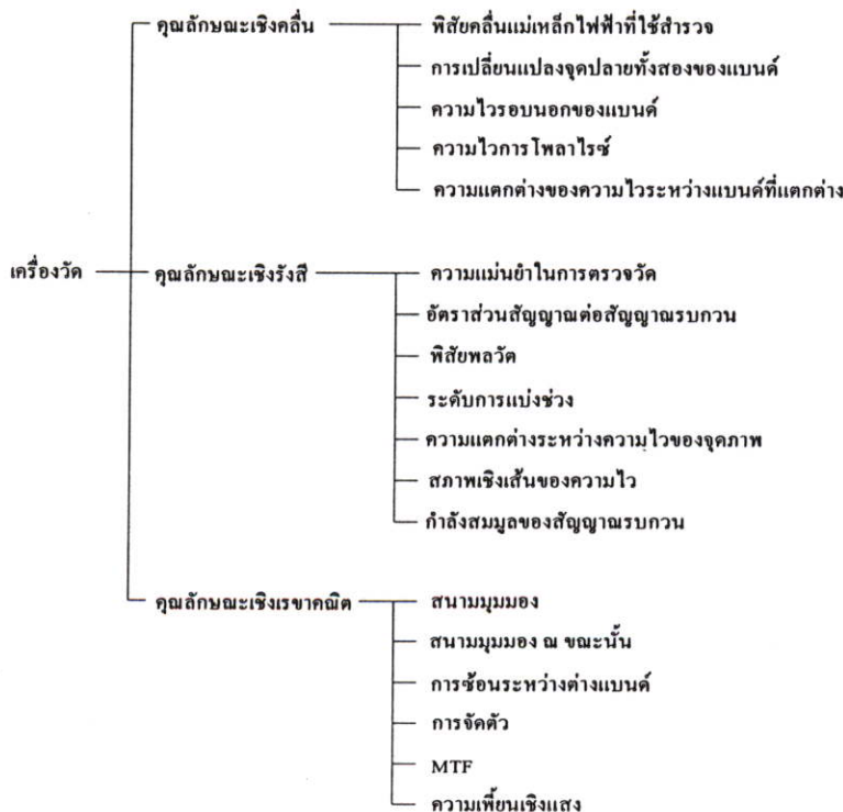
รูปที่ 2.8 องค์ประกอบของคุณลักษณะของอุปกรณ์วัดเชิงแสง
