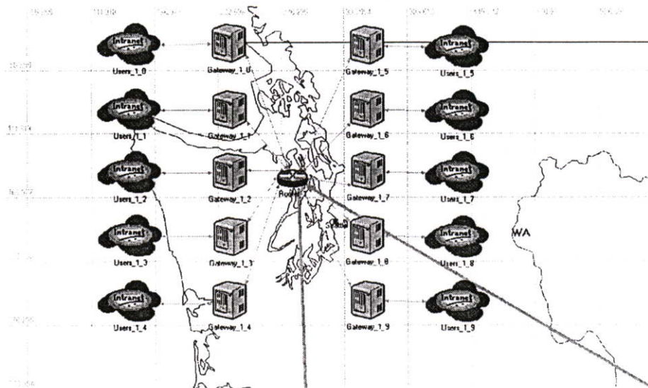
รูปที่ 4.2 โครงสร้างการเชื่อมต่อระหว่างผู้ใช้งาน เราเตอร์ขอบ และเราเตอร์หลัก
