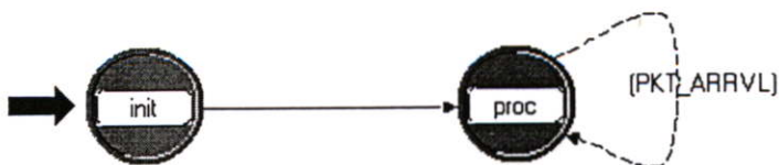
รูปที่ 3.27 โครงสร้างการทำงานของ state ภายใน โมดูล proc
