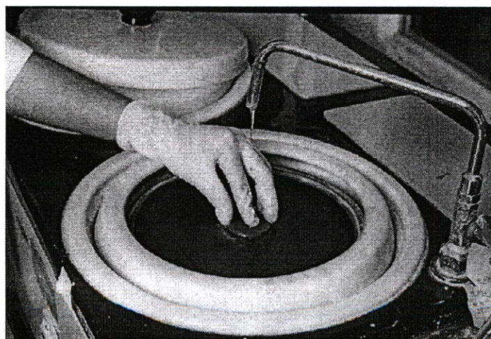
รูปที่ 2.8 แสดงการขัดตกแต่งชิ้นงาน PZT
