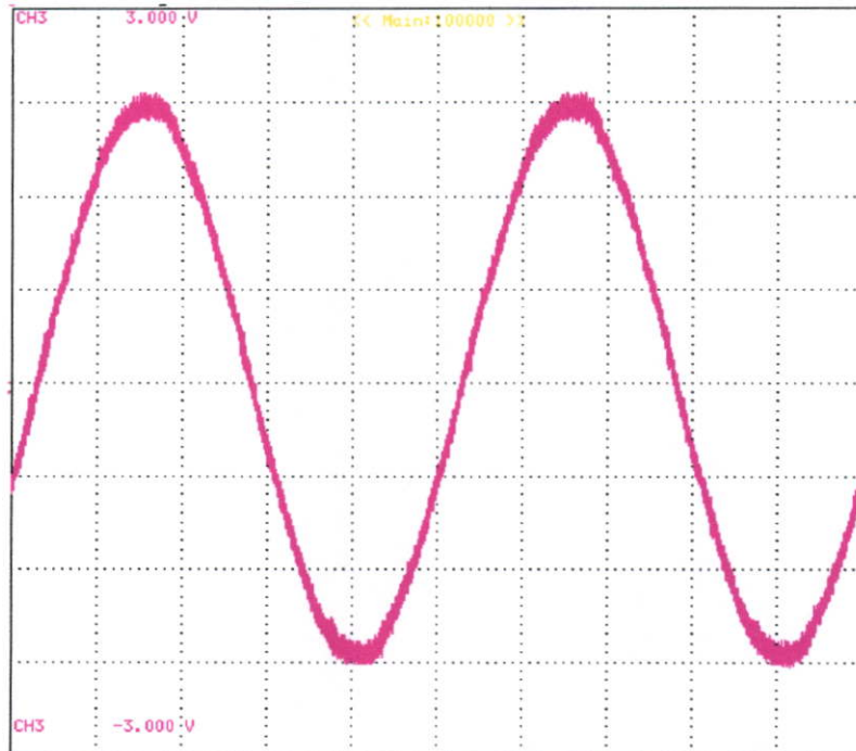
รูปที่ 4.38 แรงดันไฟฟ้าเหนี่ยวนำที่ขดลวด B coil ที่ค่าความหนาแน่นเส้นแรงแม่เหล็ก 1.48 T (0.75V/div)
