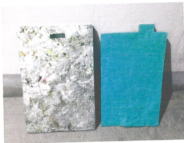
รูปที่ 2.1.3-6 แสดงการทดลองการพ่นสีแผ่น eco board
