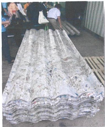
รูปที่ 2.1.3-2 แสดงการใช้งานโดยตรง แผ่น ECOboard เป็นแผ่นหลังคา
