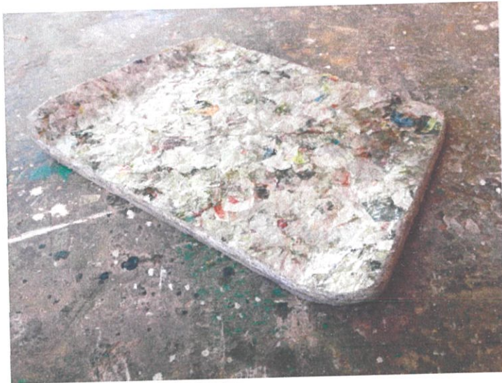
รูปที่ 2.1.3-5 แสดงการทดลองการลบเหลี่ยมมุมแผ่น eco board ด้วยเครื่องเลื่อยสายพาน
