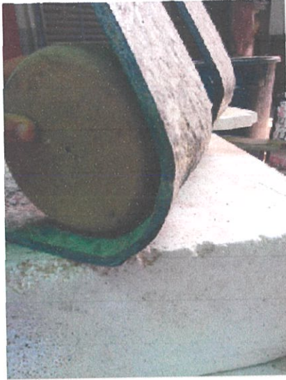
รูปที่ 2.1.3-3 แสดงการทดลองการตัด โกงแผ่น eco board ด้วยการให้ความร้อน
