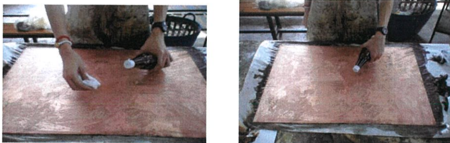
ภาพที่ 3.6 ขั้นตอนการทำความสะอาดแม่พิมพ์
