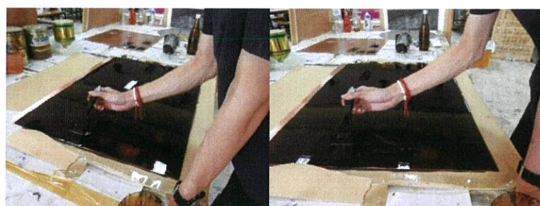
ภาพที่ 3.2 กระบวนการทาวานิชลงบนแม่พิมพ์ทองแดง
