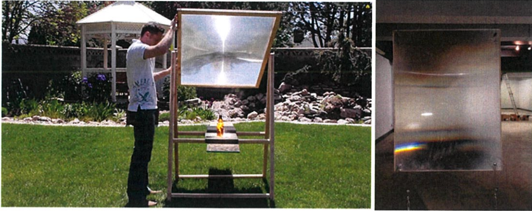
ภาพที่ 13 : ภาพแผ่นรวมแสงของจอโปรเจกชันทีวี
