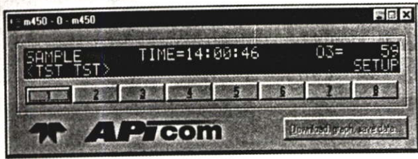
รูปที่ 8 ตัวอย่างการแสดงผลการวัดปริมาณก๊าซโอโซนที่เกิดสูงสุดจากโปรแกรมของเครื่องมือวัดก๊าซโอโซน Teledyne API Model 450H O 3 Monitor
