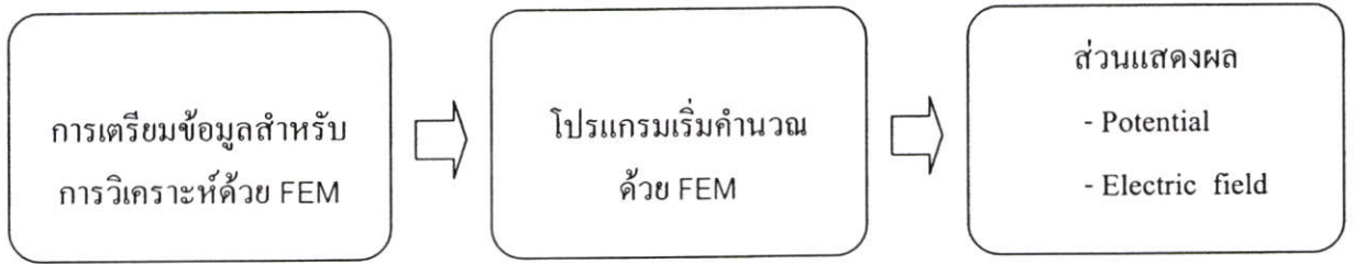
รูปที่ 3.22 ลำดับการทำงานของโปรแกรมคำนวณและวิเคราะห์ด้วยวิธีไฟไนต์เอลิเมนต์ FEM
