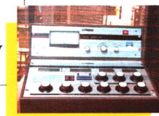
รูปที่ 3.18 การวัดค่าคาปาซิแตนซ์ของฉนวนที่เป็นไดอิเล็กตริกด้วย C-tan \delta meter
