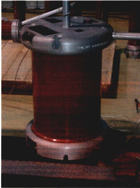
รูปที่ 3.8 หม้อแปลงกำเนิดไฟฟ้ากระแสสลับ 0-100 kV
