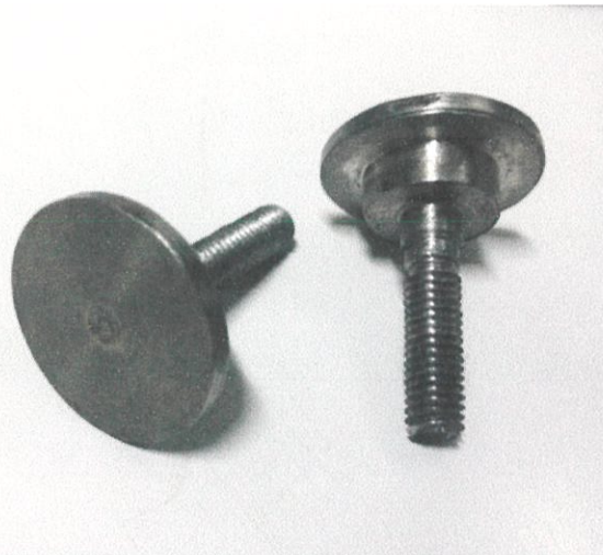
ภาพประกอบที่ 4-45 แสดงชิ้นส่วนยึดหน้าโต๊ะกับโครงที่นั่ง
