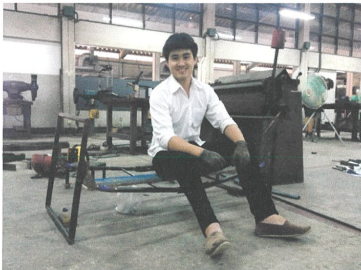
ภาพประกอบที่ 3-19 ทดลองรับน้ำหนักโครงสร้างแบบที่7(1คน)
