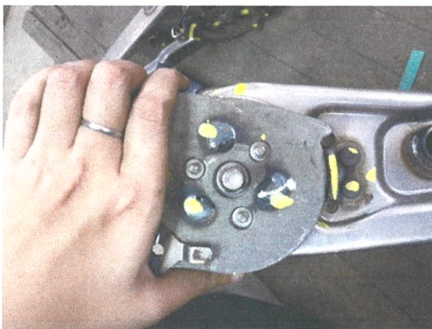
ภาพที่ 5-08 ทดลองการเชื่อมในจุดที่คาดว่าจะมีผลต่อการปรับเอนในองศาที่ต้องการ
