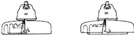
รูปที่ 1 รูปร่างที่ค้ำกันของลูกถ้วยกระแสสลับและกระแสตรง
