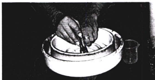
รูปที่ ก.5 การเก็บตัวอย่างเพื่อทดสอบหาค่า ESDD ผิวด้านบนลูกถ้วย
