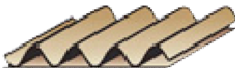
ภาพที่ 2.35 Single Face (กระดาดลูกฟูกสองชั้น)
