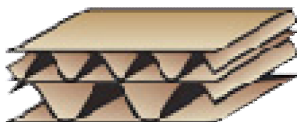
ภาพที่ 2.37 Double wall (กระดาษลูกฟูกห้าชั้น)
