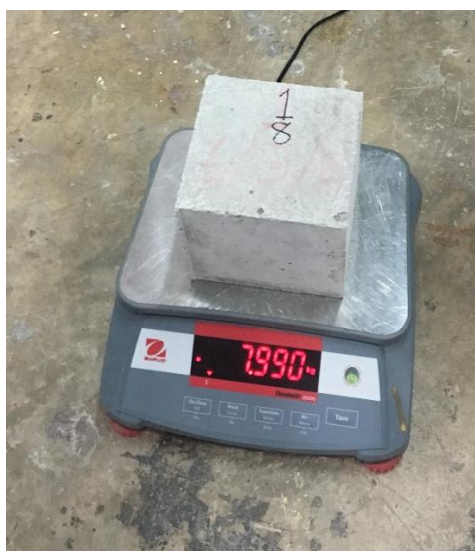
รูปที่ ค.12 การชั่งน้ำหนักตัวอย่างคอนกรีต
