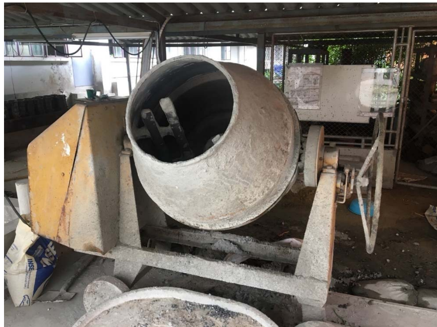
รูปที่ 3.3 โม่ผสมคอนกรีต
