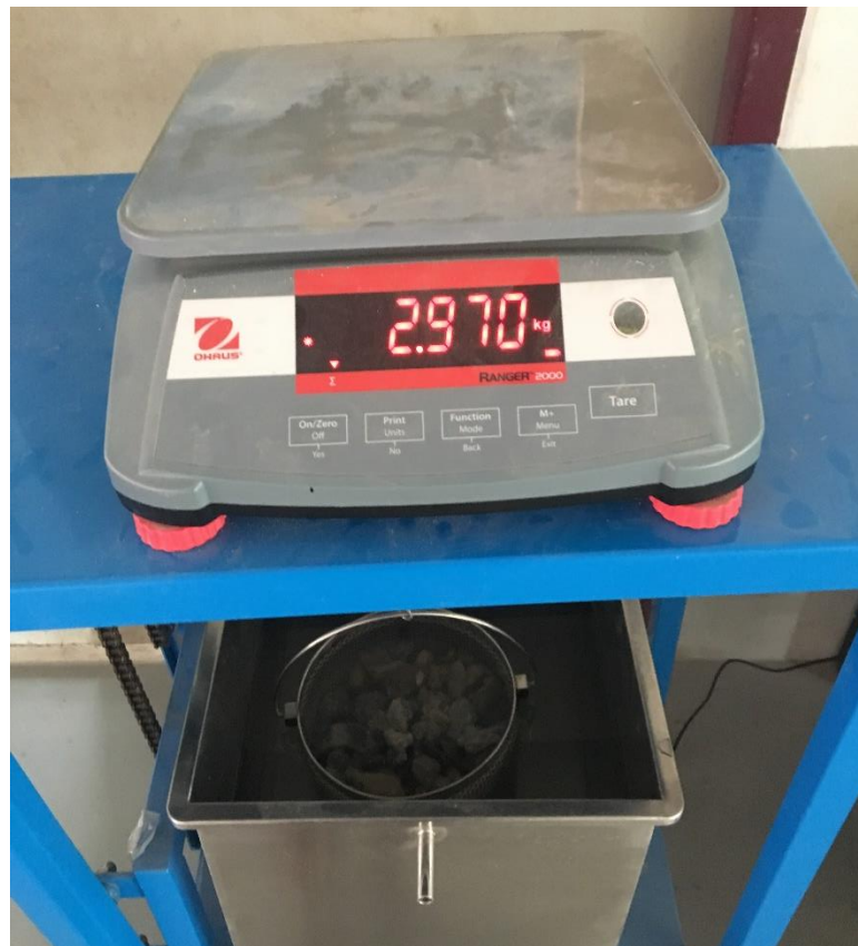
รูปที่ ค.8 การทดสอบหาค่าความถ่วงจำเพาะของมวลรวม
