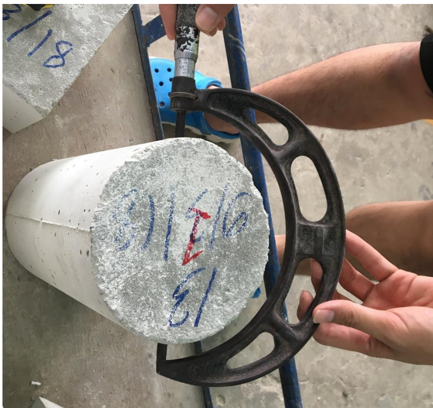
รูปที่ ค.11 การวัดขนาดตัวอย่างคอนกรีต
