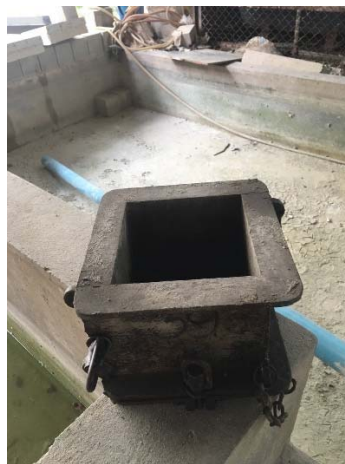
รูปที่ 3.4.ข แบบหล่อทรงลูกบาศก์ขนาด 15 \times 15 \times 15 เซนติเมตร
