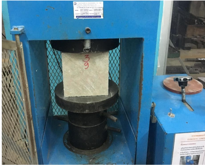
รูปที่ ค.13 การทดสอบกำลังรับแรงอัด
