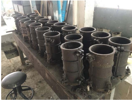
รูปที่ 3.4.ก แบบหล่อทรงกระบอกขนาด \varnothing 15 \times 30 เซนติเมตร
