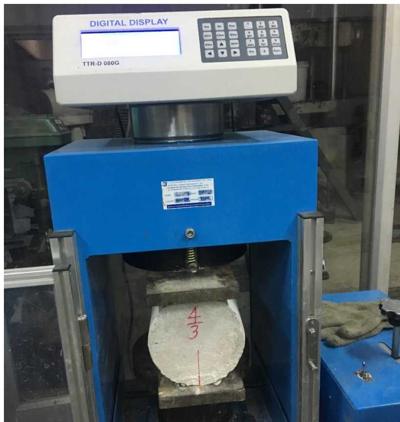
รูปที่ ค.14 การทดสอบกำลังรับแรงดึง
