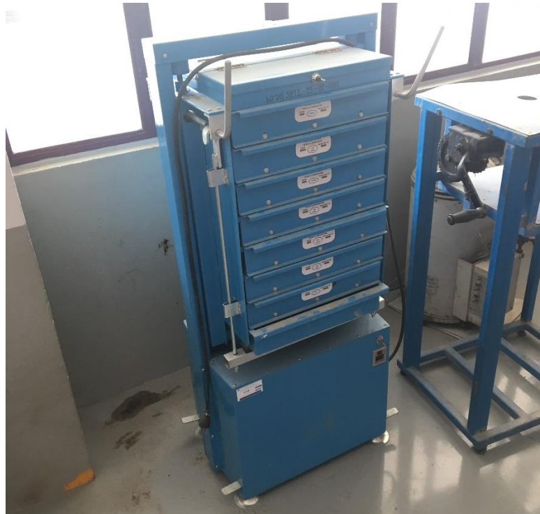
รูปที่ ค.7 การทดสอบหาส่วนคละของมวลรวม
