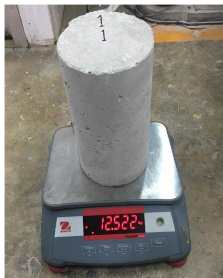
รูปที่ ค.12 การชั่งน้ำหนักตัวอย่างคอนกรีต
