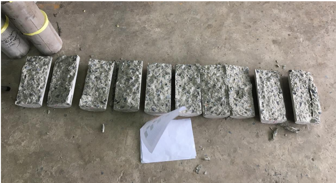
รูปที่ ค.16 ตัวอย่างคอนกรีตที่ผ่านการทดสอบการรับแรงดึง
