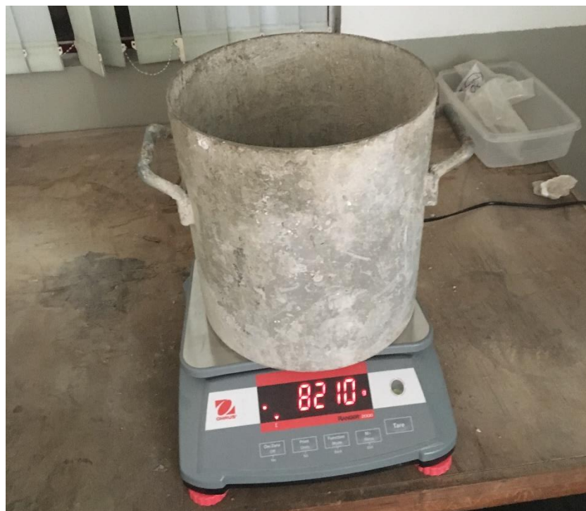
รูปที่ ค.6 การทดสอบหาค่าหน่วยน้ำหนักของมวลรวม
