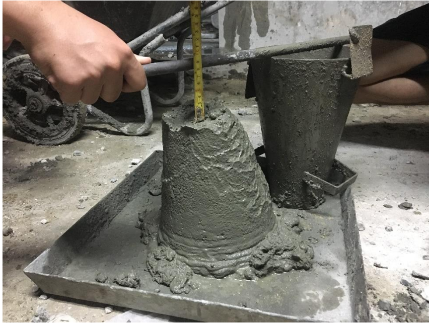
รูปที่ ค.9 การตรวจสอบค่าการยุบตัวของคอนกรีต
