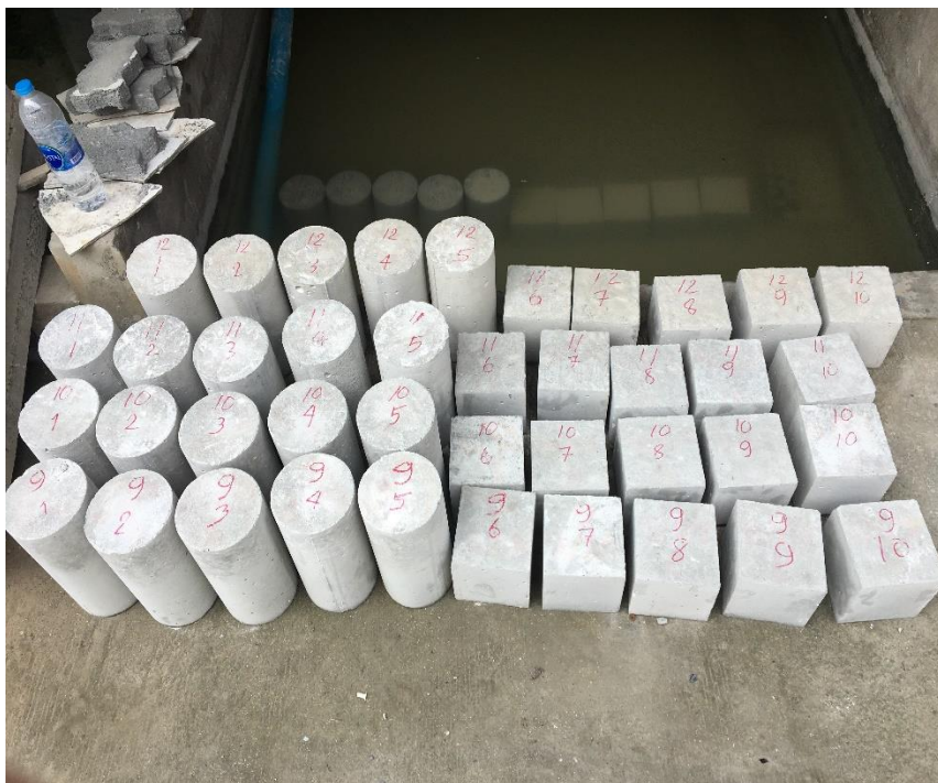
รูปที่ ค.10 ตัวอย่างบางส่วนของตัวอย่างคอนกรีตที่ผสมเสร็จแล้ว
