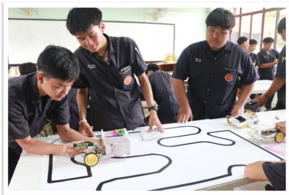
นักเรียนทดสอบประสิทธิภาพการเคลื่อนที่ของรถขนของเดินตามเส้นทาง
