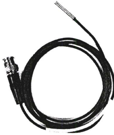
รูปที่ 5.3 ไฮโดรโฟนที่ใช้ในการทดลอง
