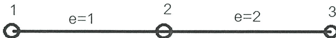
รูปที่ 2.24 แสดงการแบ่งเอเลเมนต์สำหรับปัญหา 1 มิติ และเลขดัชนี
