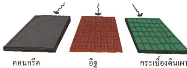
ภาพที่ 2.21 ลักษณะของวัสดุปูพื้นภายนอกที่กักเก็บความร้อนได้ต่ำ และสูง
