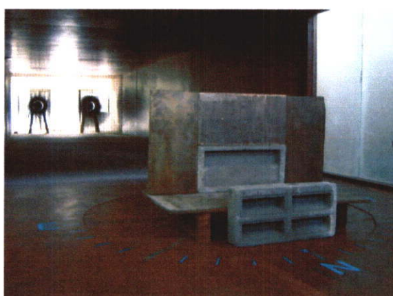
ภาพที่ 4.14 แสดงเครื่องมืออุปกรณ์ในการทำการทดลอง เพื่อหาความเร็วลมที่ลอดผ่านช่องบล็อก
