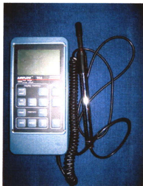
ภาพที่ 3.39 แสดงเครื่องวัดอุณหภูมิ วัดความชื้น และ เครื่องสอท วายร์ แอนนิโมมิเตอร์ (Hot Wire Anemoter)
