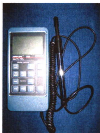
ภาพที่ 3.7 เครื่องมือที่ใช้วัดหาอัตราเร็วลม อุณหภูมิ และ ความชื้นสัมพัทธ์
