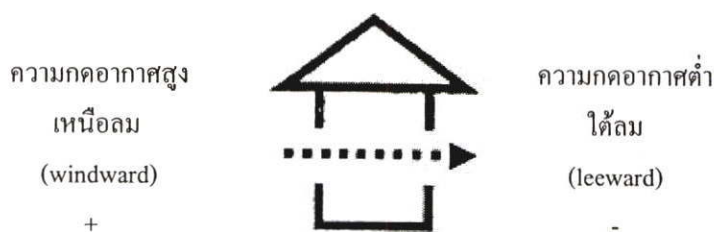
ภาพที่ 2.5 แสดงลมทะลุผ่านอาคาร โดยอาศัยหลักการเคลื่อนที่ด้วยความกดอากาศ
