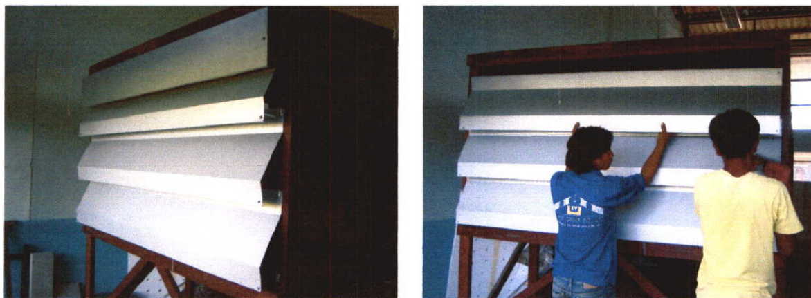
ภาพที่ 4.17 แสดงการใช้กระเบื้องบานเกล็ดเพื่อทำการวัดหาความเร็วลม และการติดตั้ง
