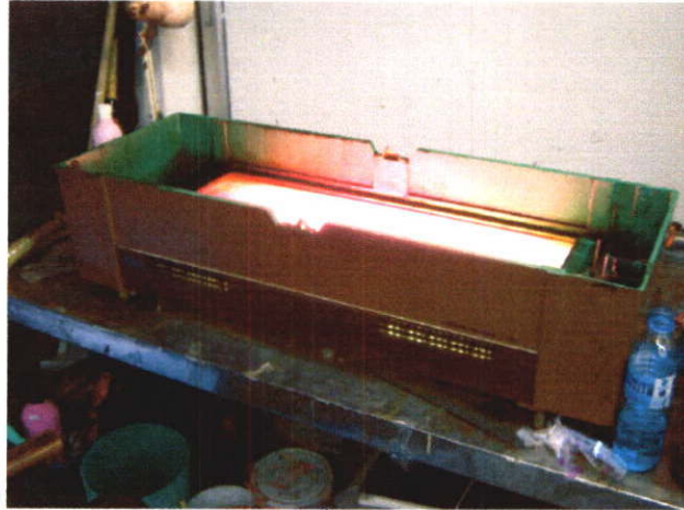
ภาพที่ 3.40 แสดงเครื่อง โต้ะน้ำ (Flow Visualization Apparatus)
