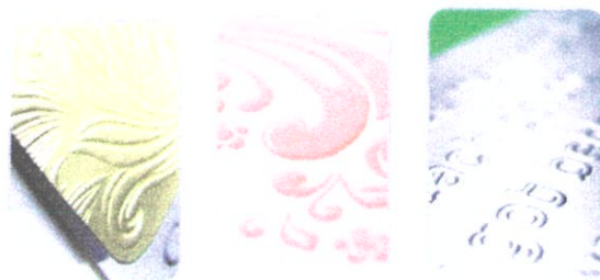
ภาพที่ 2.6 การปั้มนูนฝอยเงิน ฝอยทอง แผ่นโลหะ
