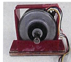
รูปที่ 6 เครื่องกำเนิดไฟฟ้าขนาด 28 วัตต์, 140 โวลต์, 8 ขั้ว, 1500 rpm
