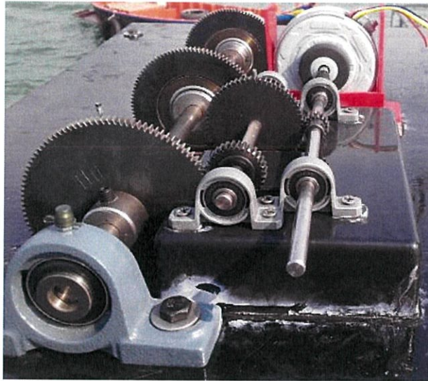
รูปที่ 3.12 ระบบเฟืองขับและเฟืองเพิ่มรอบที่นำมาประกอบกันแล้ว
