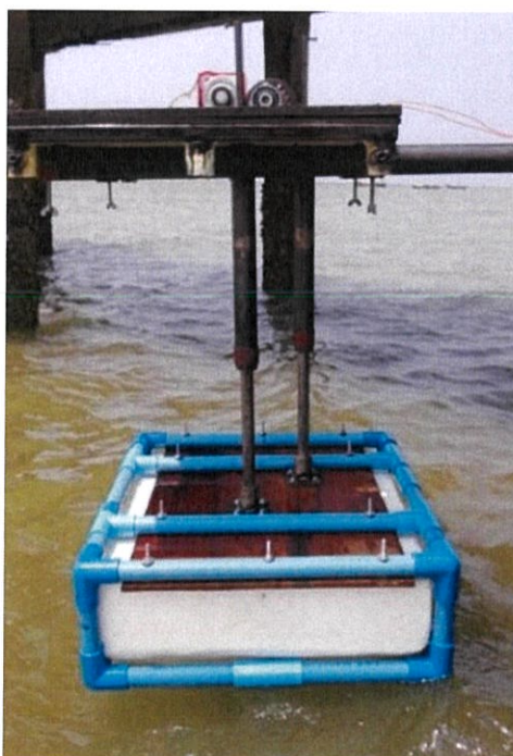
รูปที่ 4.8 การทดสอบต้นแบบเครื่องกำเนิดไฟฟ้าจากพลังงานคลื่น
