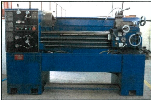
รูปที่ 3.14 เครื่องกลึง (Turning machine)
