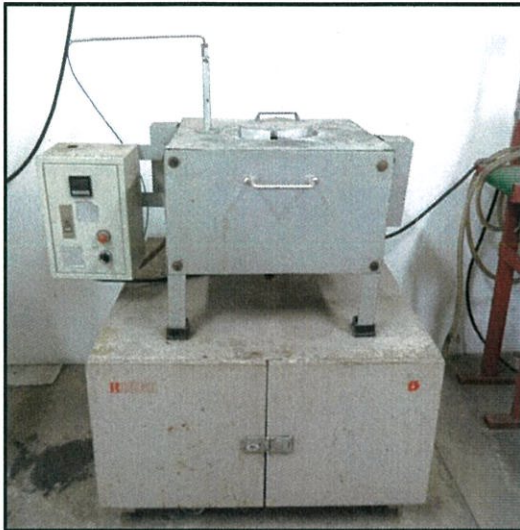
รูปที่ 3.19 เครื่อง Electrical melting furnace
