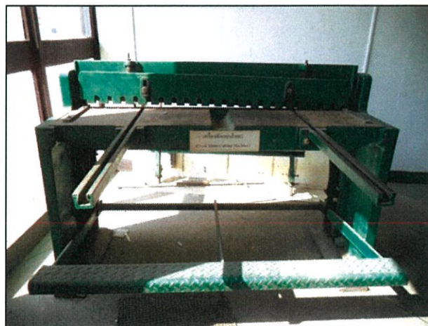
รูปที่ 3.23 เครื่องตัดแผ่นโลหะ (Sheet metal cutting machine)
