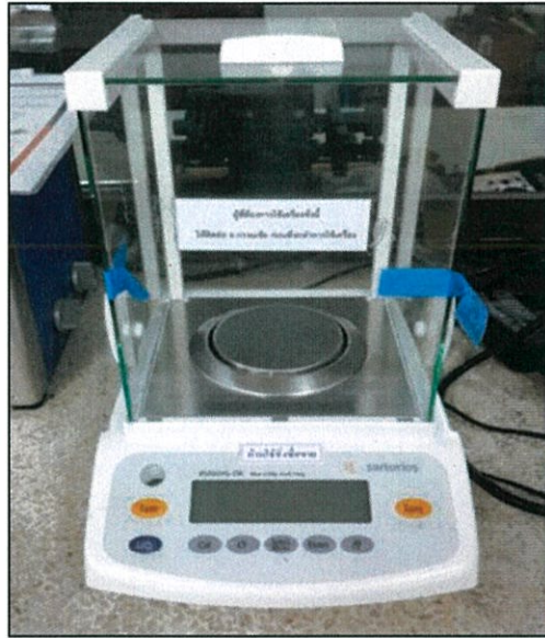
รูปที่ 3.22 เครื่องชั่งน้ำหนักยี่ห้อ Sartorius รุ่น BSA224S-CW
