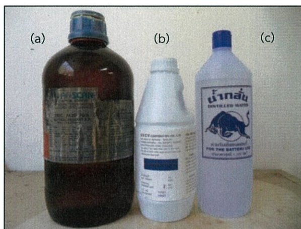
รูปที่ 3.25 สารเคมีทำความสะอาดแผ่นทองแดง (a) กรดไนตริก (b) เอทานอล และ (c) น้ำกลั่น
