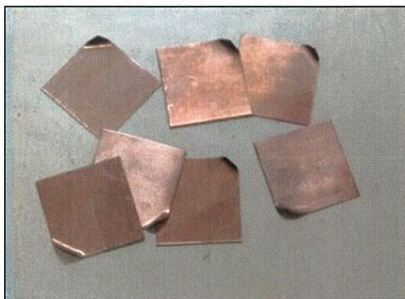
รูปที่ 3.24 ตัวอย่างแผ่นทองแดงหลังทำการตัดและพับมุม
