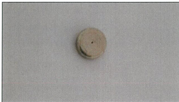
รูปที่ 3.21 ตัวอย่างชิ้นงานทดสอบที่ได้หลังจากการหล่อ
