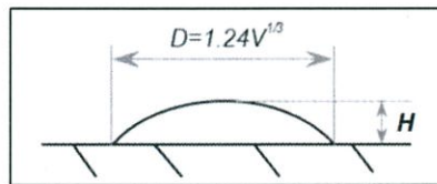
รูปที่ 2.10 ความสูงและเส้นผ่านศูนย์กลางของโลหะบัดกรี
