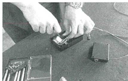
รูปที่ 3.2 แสดงการประกอบเซนเซอร์กับกล่องสำหรับใส่แผงวงจร
