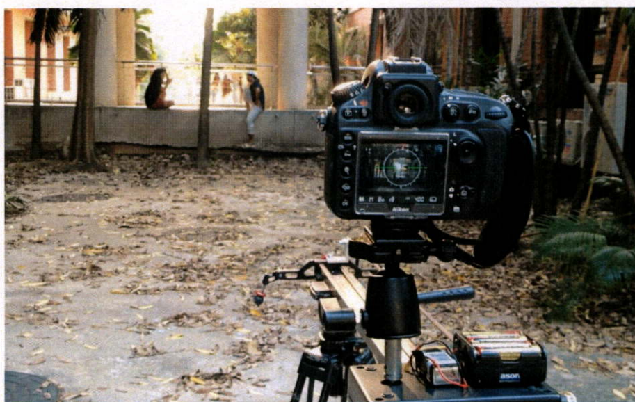
ภาพที่ 42 ทดลองอุปกรณ์นอกสถานที่ โดยยกสูงตามแนวระดับ (ติดกับขาตั้งกล้องเล็ก 2 ตัว)
