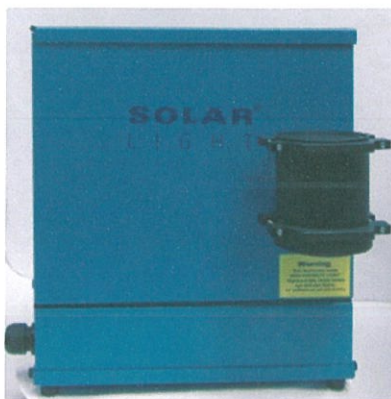
รูปที่ 3.14 แหล่งกำเนิดแสงจากหลอดไฟซีนอน
