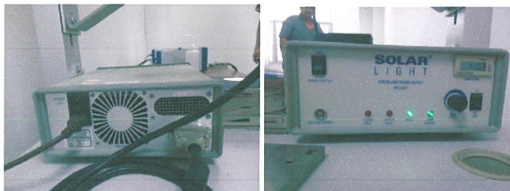
รูปที่ 3.19 กดปุ่มด้านหลังและด้านหน้าของเครื่อง Xenon Lamp Power Supply (XPS300)
