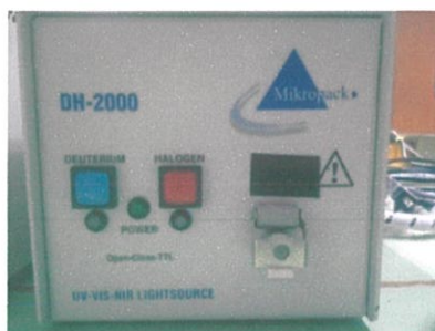
รูปที่ 3.11 แหล่งกำเนิดแสง DH-2000 UV-VIS-NIR Light Source
