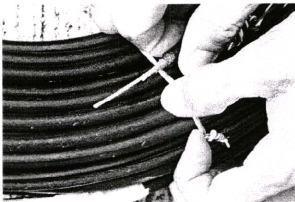
รูปที่ 3.40 เส้นใยแก้วนำแสง ที่เคลื่อนออกจาก Loose Tube เมื่อ Loop สาย
