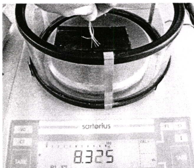
รูปที่ 3.32 หาค่าแรงเค้นสูงสุดของเส้นใยแก้วนำแสง ด้วยเครื่องชั่งละเอียด
