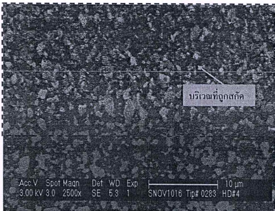
รูปที่ 5.12 แสดงบริเวณพื้นผิว ABS หลังจากการสกัดโดยใช้ SEM
