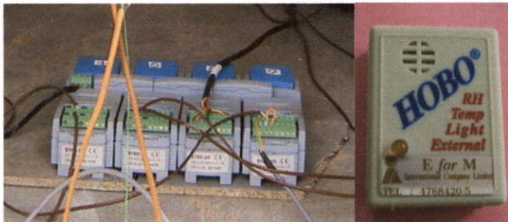
รูปที่ 3.6 เครื่องบันทึกข้อมูล OPUS 200, HOBO onset data logger
