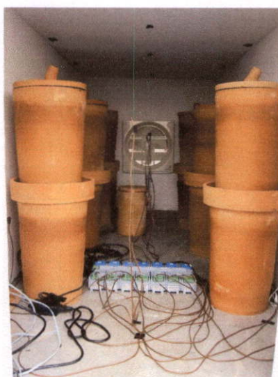
รูปที่ 4.3 แสดงการติดตั้งภาชนะดินเผาและตำแหน่งหัววัดภายในห้องทดสอบ
