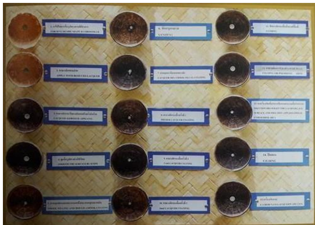
ภาพที่ 2.16 ขั้นตอนการขึ้นรูปและทาเคลือบยางรัก
