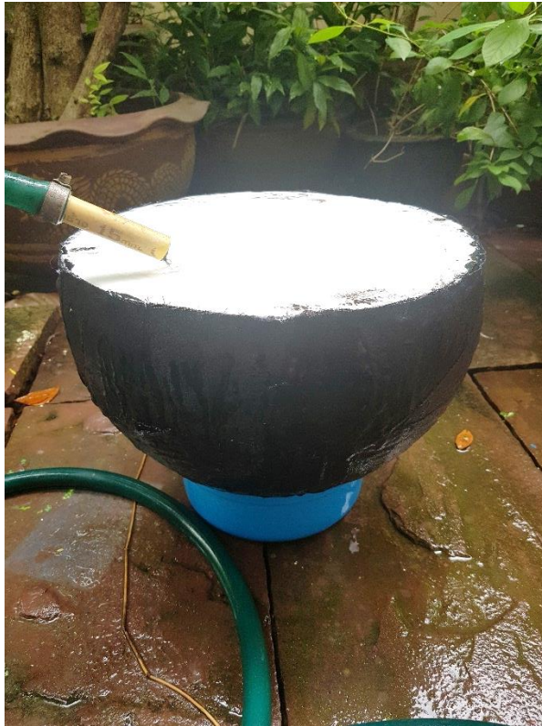
ภาพที่ ง.10 นำต้นแบบที่ผ้าและยางรักเกาะตัวกันจนแห้งสนิทแล้ว แฉ่นำเพื่อทำให้กาวแป้งเปียกละลาย
