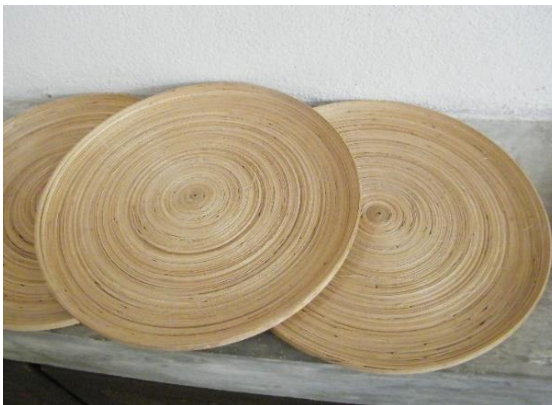
ภาพที่ 2.13 โครงภาชนะเครื่องรักหรือเครื่องเงินจากไม้ไผ่เย็บโดยการขดชิ้นรูป ถ่ายโดย : สนั่น รัตน์ะ (ถ่ายเมื่อ 22 สิงหาคม 2558)
