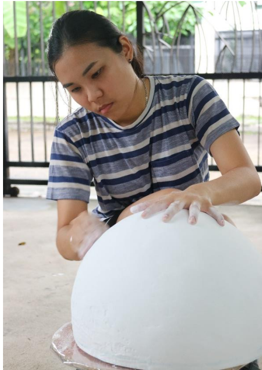
ภาพที่ ง.6 เมื่อปูนปลาสเตอร์แห้งสนิท ใช้เครื่องมือแต่งปูนแต่งผิวปูนปลาสเตอร์และขัดด้วยกระดาษทรายเบอร์ละเอียด ให้เรียบเสมอกัน
