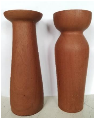
ภาพที่ 4.2 ไม้มะม่วงที่ผ่านการขึ้นรูปด้วยการกลึง
