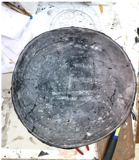
ภาพที่ ง.11 ใช้เส้นลวดตามขอบชิ้นงานเพื่อให้จัดทรงได้ง่ายขึ้น
