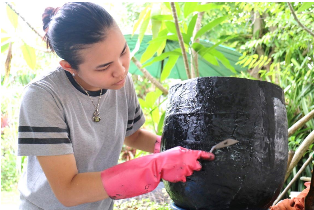
ภาพที่ ง.13 นำยางรักกับดินสอพองผสมให้เข้ากัน โป้วอุดร่องรอยให้พื้นผิวด้านในและด้านนอก เรียบเสมอกันจนทั่วชิ้นงาน และทิ้งให้แห้งสนิท
