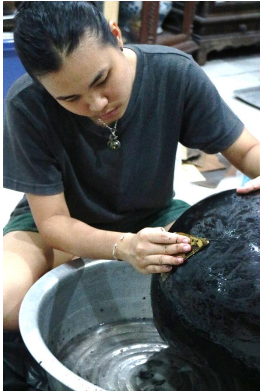
ภาพที่ ง.14 ขัดพื้นผิวชิ้นงานให้เรียบด้วยกระดาษทรายน้ำ เบอร์ 220 320 และ 600
