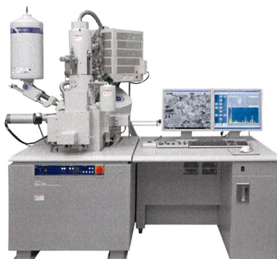
รูปที่ 3.5 แสดงภาพกล้องจุลทรรศน์อิเล็กตรอนแบบส่องกราด (SEM) [42]
