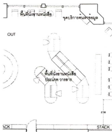
ภาพที่ 4.50 แสดงแปลนการจัดวางเครื่องเรือนบริเวณส่วนหนังสือนิตยสาร วารสาร และหนังสือพิมพ์ ห้องสมุดของศูนย์สร้างสรรค์งานออกแบบ ประกอบด้วย ที่นั่งแบบม้านั่งยาวสำหรับ 32 ที่นั่ง ชั้นวางนิตยสาร และจุดบริการค้นหาข้อมูล
