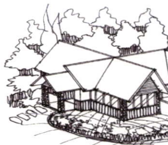
อาคารที่ปรับปรุง โดยการใส่หลังคาคานหน้า และผนังกรุด้วยปิกไม้
