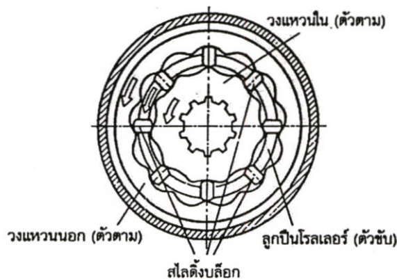
รูปที่ 4.18 แสดงการหมุนเคลื่อนที่ของวงแหวนใน วงแหวนนอก และสไลด์บังคับล็อก ซึ่งทำให้เกิดการล็อกเคลื่อนตัวไปด้วยกัน
