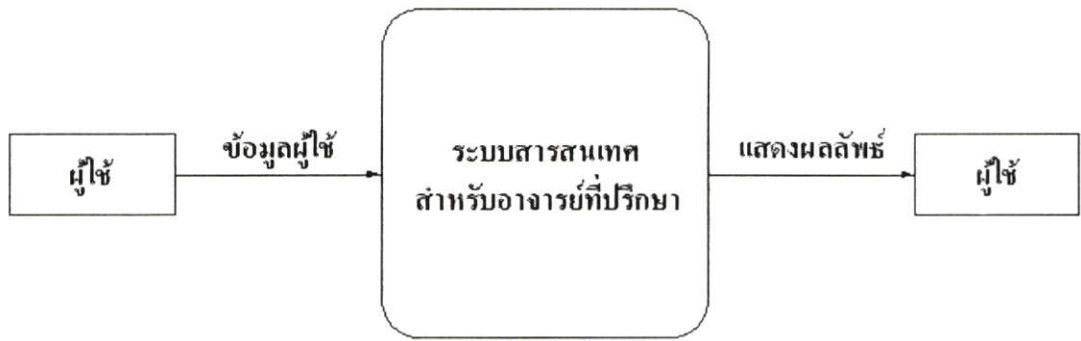
ภาพที่ 3.1 แสดง Data Flow Diagram Level 0 ระบบสารสนเทศสำหรับอาจารย์ที่ปรึกษา
