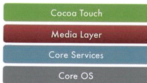
รูปที่ 2.13 รูปชั้น โครงสร้างของระบบปฏิบัติการ iOS
