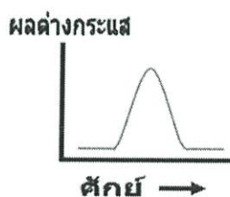
รูปที่ 2.29 กราฟแสดงโวลแทมโมแกรมของพัลส์โวลแทมเมตรีแบบสแควร์เวฟ [26]
