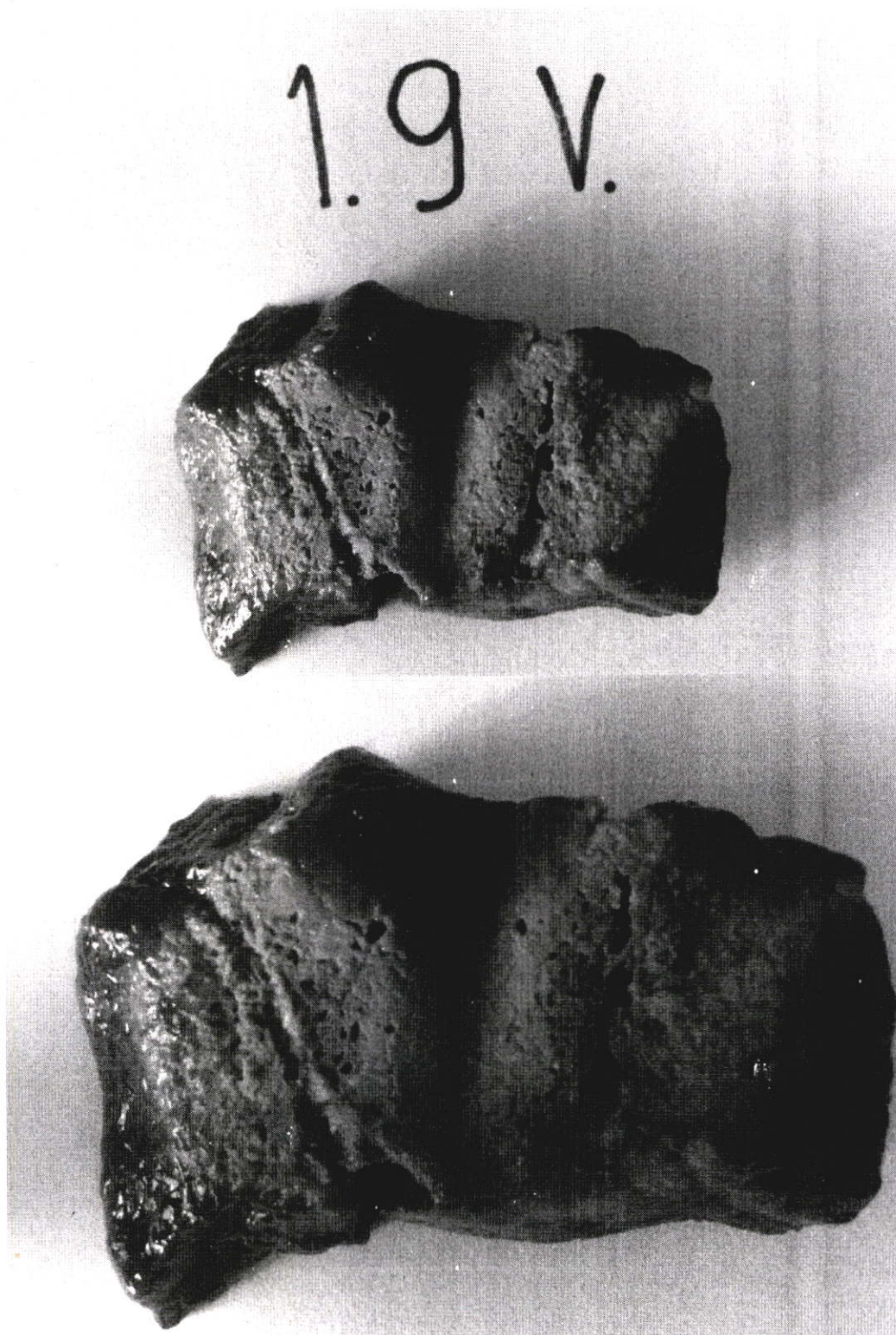
รูปที่ 4.11 การทดลอง โดยทำการทดสอบกับเครื่องทำลายเซลล์มะเร็งขนาด 1 แท่งจ่าย ปรับกำลังงาน ไฟตรงเพื่อป้อนให้กับชุด จ่ายคลื่นไมโครเวฟขนาด 1.9 โวลท์
