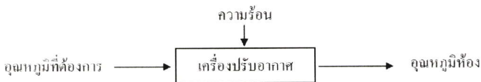
รูปที่ 2.2 การควบคุมอุณหภูมิห้องด้วยเครื่องปรับอากาศ
