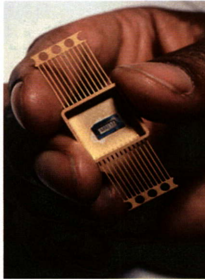
รูปที่ 3.13 เครื่องตรวจวัดปริมาณกลูโคสโดยใช้พอร์ซซิลิคอน [58]
