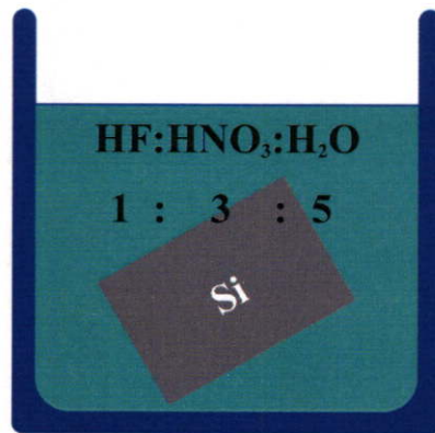
รูปที่ 3.10 การสร้างพอร์สซิลิคอนด้วยวิธีการกัดย้อมสี
