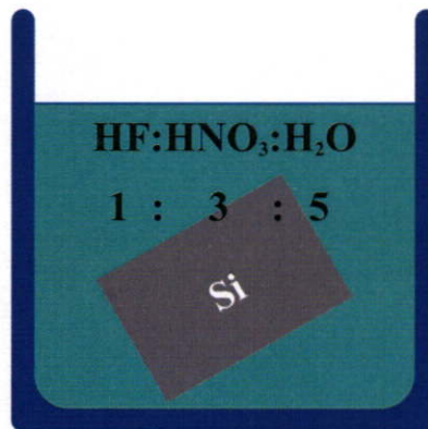
รูปที่ 4.3 การสร้างชั้นพอร์ซซิลิคอนด้วยวิธีการกัดข้อมล
