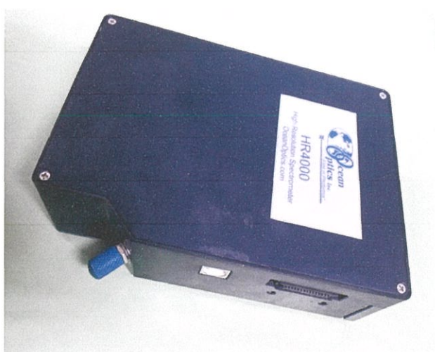
รูปที่ 3.12 เครื่องสเปกโตรมิเตอร์ Ocean Optic HR4000
