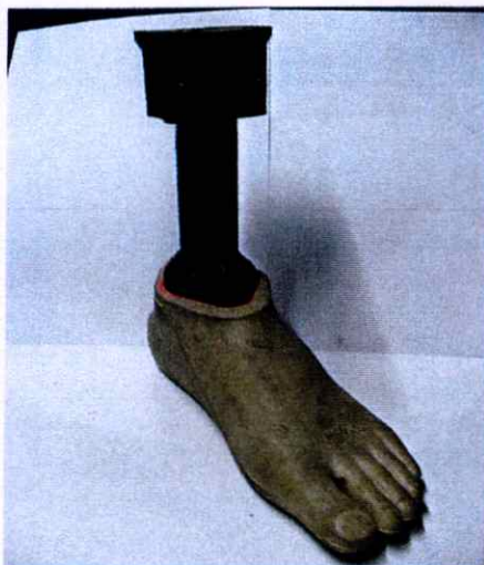
ภาพที่ 4.9 ชิ้นส่วนใต้เท้าที่ใช้ร่วมกับข้อเท้าเทียม
