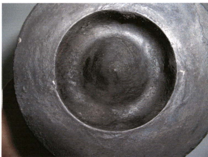
รูปที่ 5.12 แสดงลักษณะเขม่าการเผาไหม้ของน้ำมันยางพาราผสมในเครื่องยนต์
